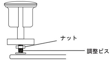
ナットを緩め、排水栓が適切に開閉するようポップアップ調整ビスの長さを調整し(0-15mm)ナットを締め固定してください。
