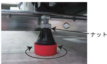
設置場所に仮設置し、端部に樹脂を回して高さを調節し最後にナットで固定してください。
