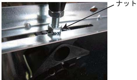
ナットを緩め、樹脂部を左右にスライドさせて取付ピンの位置に合わせ
