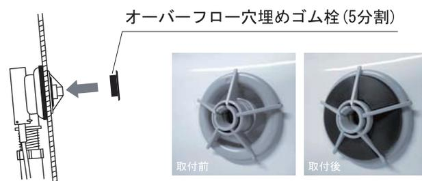
このゴム栓(5分割)はオーバーフローフランジ部に差込むことにより、オーバーフローさせず、より深い水位を確保できます。ゴムに少量の石鹸水を塗布し、確実に差込んでください。ゴム栓の差し込みが浅いとオーバーフローフランジのゆるみの原因となります。
