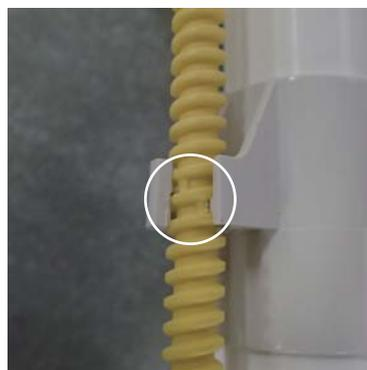
写真のようにボルトに2ヵ所突起があります。
